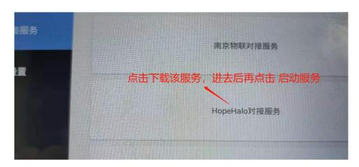
上面的操作完成后,即可开始添加设备。有两种方式,一是重启自研主机,主机自动扫描添加;二是通过输入 ip 和端口号手动添加,ip 可在 WiFi 设置或上面的服务中查看,端口号固定为 21501。手动添加参见 截图示例。
